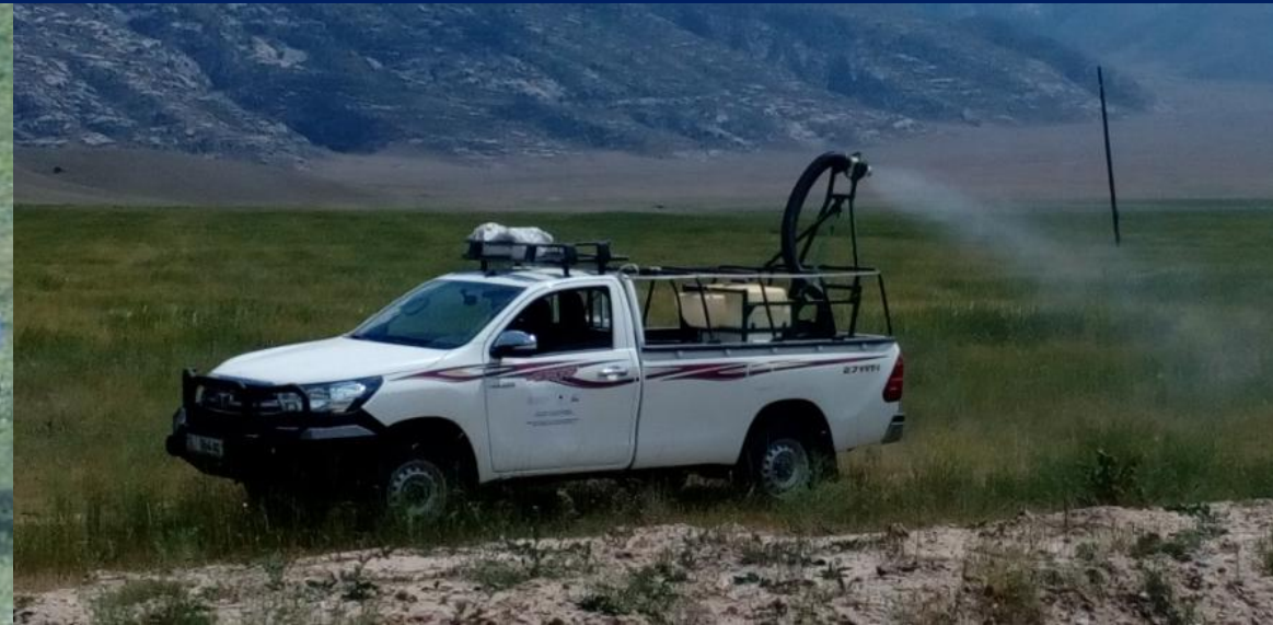
Обприскування УМО, 1 л/га, Автомобіль. До 400 га в день
