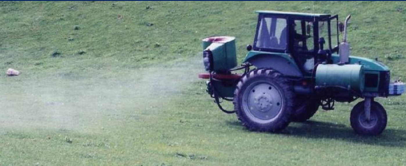
Повнооб'ємне обприскування, 400 л/га, Трактор. Максимально 20 га в день
